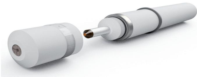
Grafik 2: Membranbedeckter amperometrischer Sensor geöffnet, Quelle: aqua&pools
